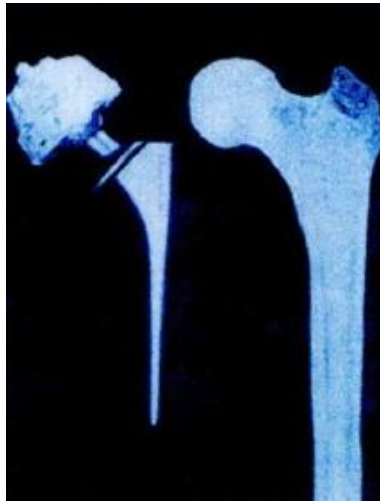
Slika 9. Keramički kuk (lijevo) i pravi kuk (desno)[6]
