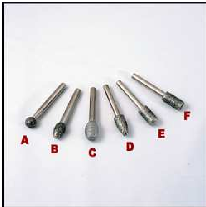
Slika 8. Galvanizirani alati za obradu kamena [ 6 ]
