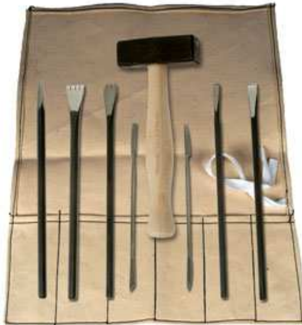
Slika 7. Set ručnog alata kamenoklesara
