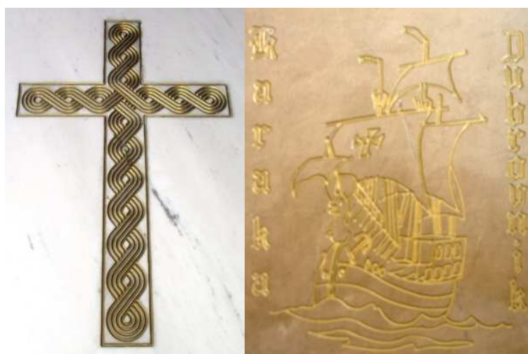
Slika 3. Primjeri jednostavnijih kamenih površina s konstantnom dubinom rezanja
