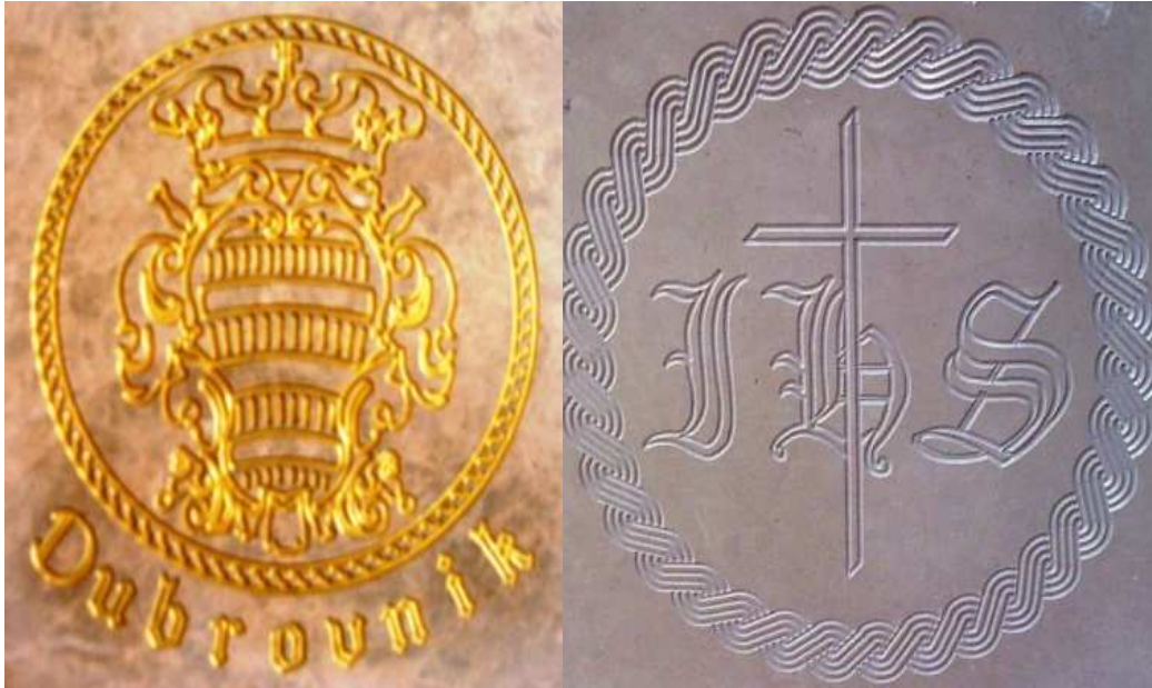
Slika 4. Primjeri kompleksnijih reljefa s konstantnom dubinom rezanja
