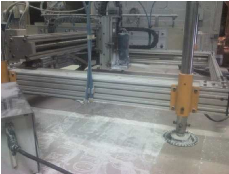
Slika 16. Prikaz obrade kamenog bloka s prijenosnim strojem za graviranje
