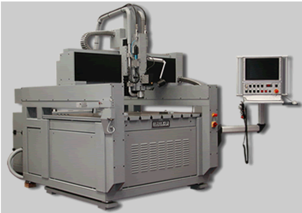
Slika 13. Numerički upravljani stroj za graviranje kamena INCISOGRAFO MH 1000 [ 5 ]
