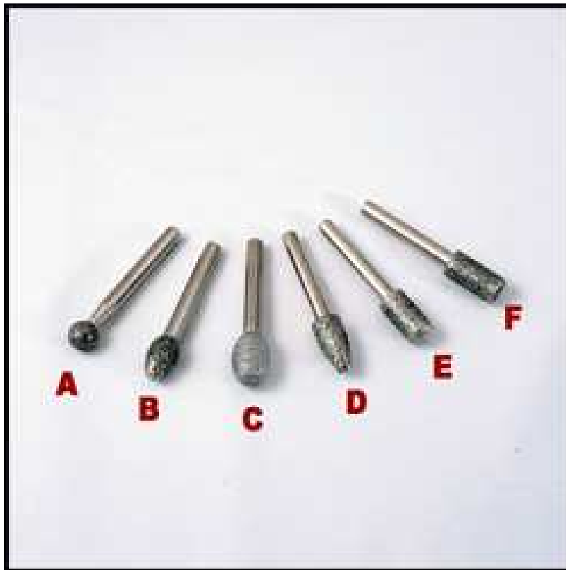
Slika 8. Galvanizirani alati za obradu kamena [ 6 ]
