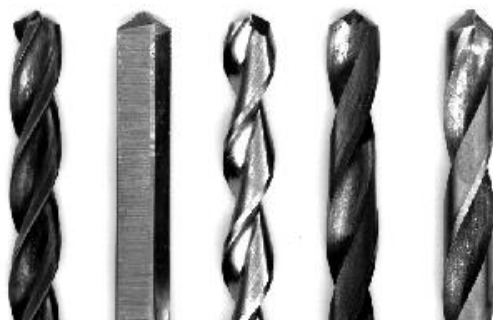
Slika 12. Svrkla sa različitim brojem oštrica [2]
