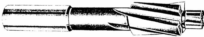
Slika 27. Upuštalo sa fiksnom vodilicom [4]
