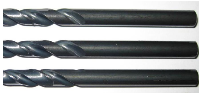
Slika 8. Primjer cilindričnog prihvata svrdla [4]
