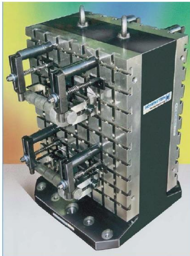
Slika 61. Primjer obratka stegnutog sa fleksibilnim priborom [4]
