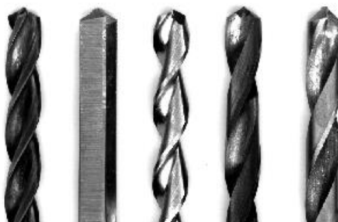
Slika 12. Svrkla sa različitim brojem oštrica [2]
