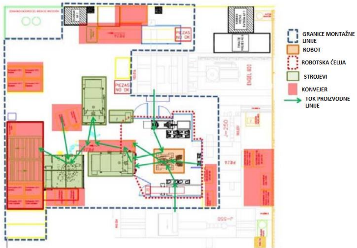
Slika 34. Tlocrt poluautomatske proizvodne linije [68]
