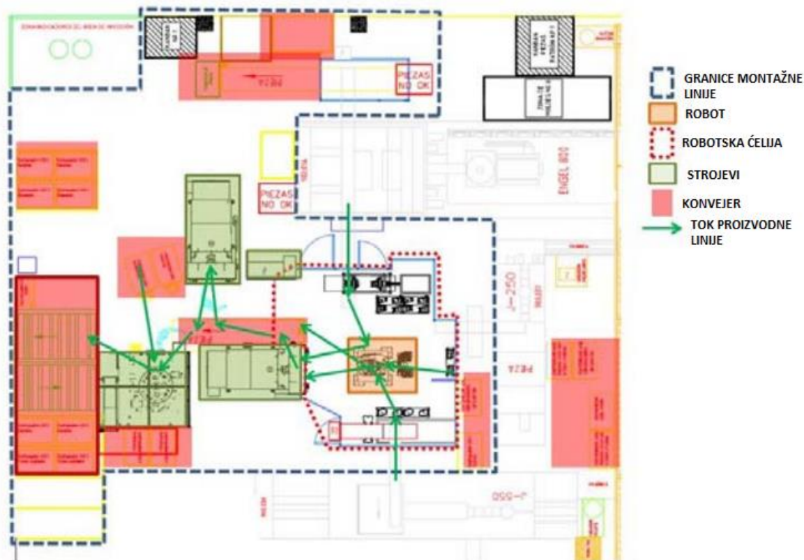
Slika 34. Tlocrt poluautomatske proizvodne linije [68]
