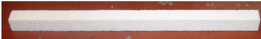
Slika 6.3 Polistirenski model za probno lijevanje
