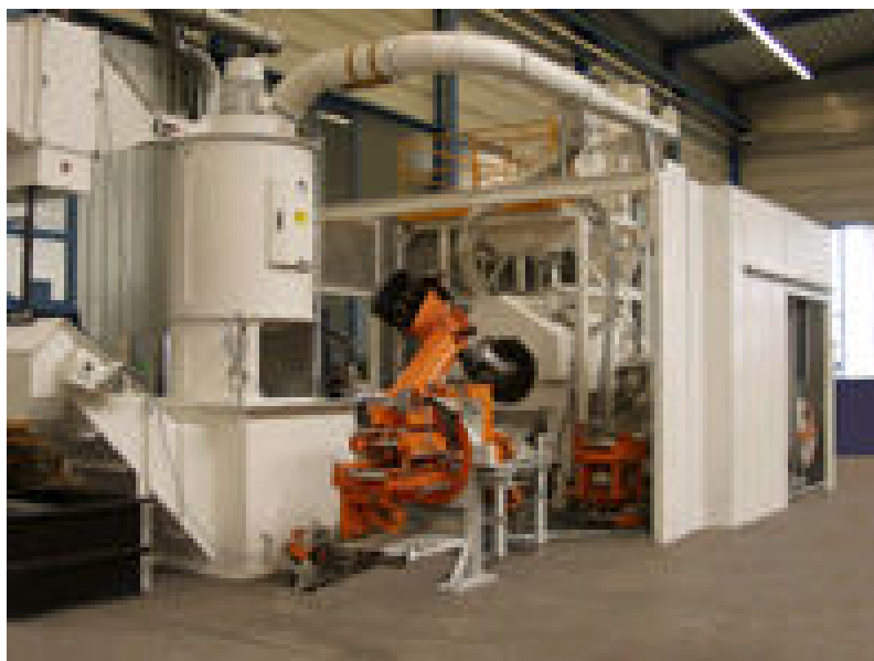
Slika 3.14 Automatsko sačmanje odljevaka tvrtke Rösler pomoću robota Roboblaster RROB 350/1200-4 [12]
