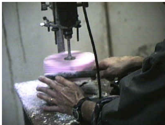
Slika 2.9 Proizvodnja modela od pjenastog polistirena [8]
