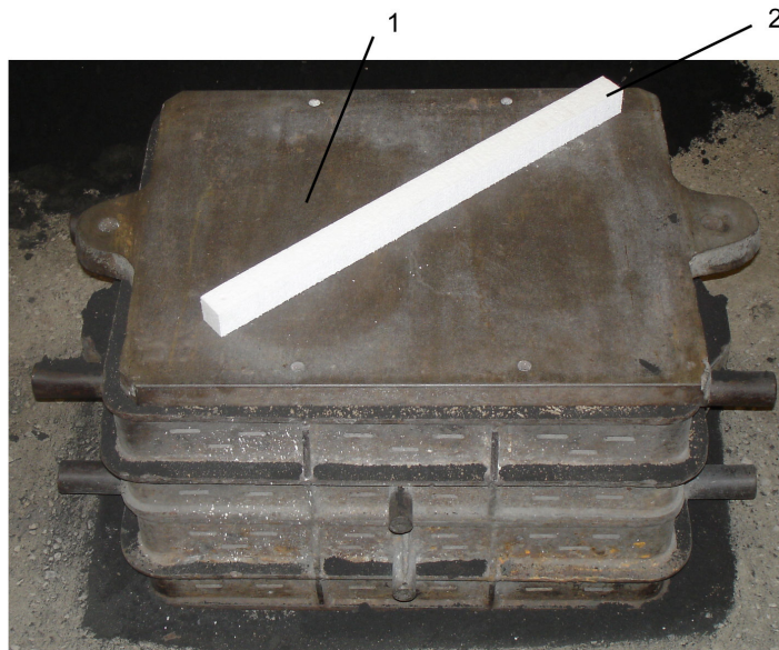
Slika 6.5 Prikaz kalupljenja 1 – modelna ploča 2 – polistirenski model
