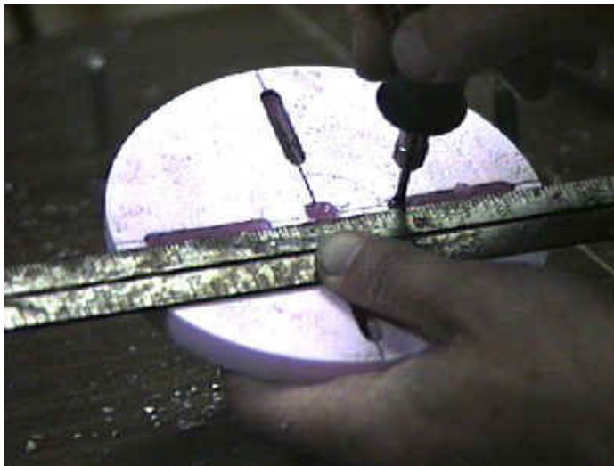
Slika 2.10 Izrada modela od pjenastog polistirena za čelični odljevak [8]
