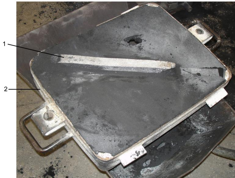
Slika 6.14 Odljevak lijevan korištenjem polistirena gustoće  $30 \text{ kg/m}^3$
