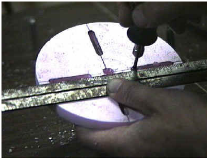
Slika 2.10 Izrada modela od pjenastog polistirena za čelični odljevak [8]
