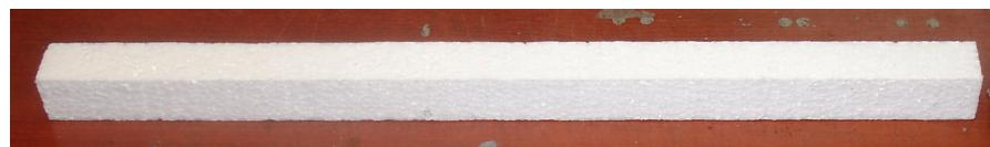
Slika 6.3 Polistirenski model za probno lijevanje
