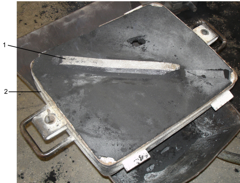
Slika 6.14 Odljevak lijevan korištenjem polistirena gustoće 30 \text{ kg/m}^3
