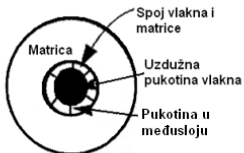
f) Radijalne pukotine spoja i uzdužne pukotine vlakna
