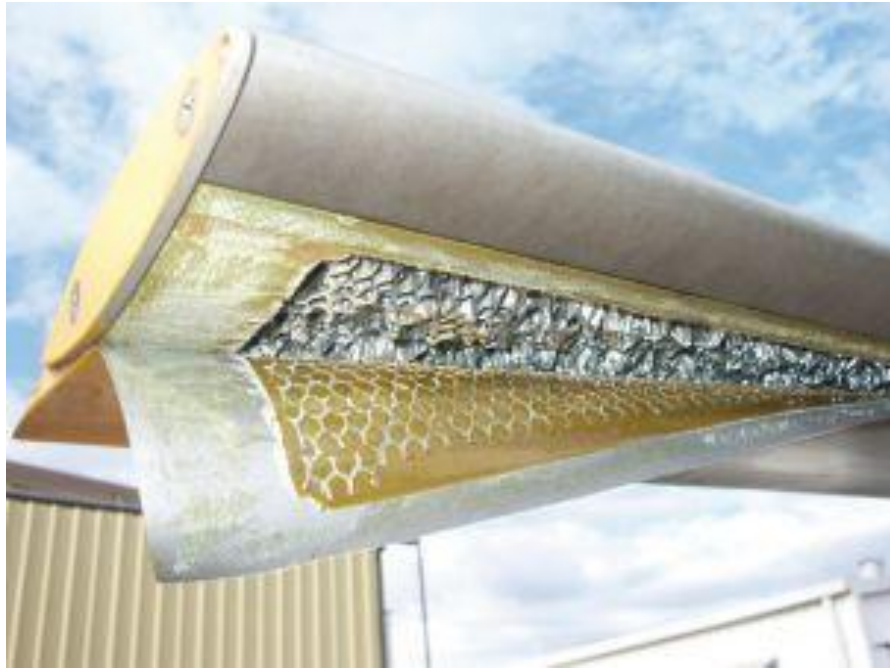
Slika 11 – Delaminacija na rotorskoj lopatici helikoptera
