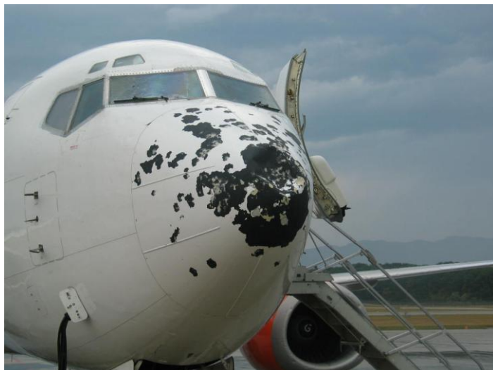
Slika 15 - Udarne oštećenja uslijed tuče
