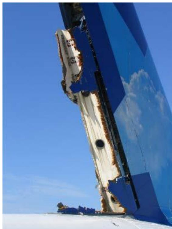
Slika 19 – Popuštanje sendvič konstrukcije uslijed kombinacije djelovanja vlage i niske temperature
