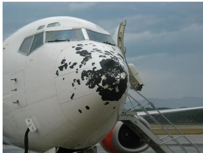
Slika 15 - Udarna oštećenja uslijed tuče
