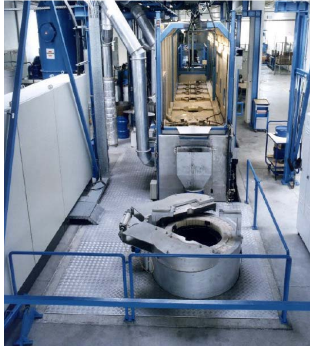
Slika 11. Automatizirano postrojenje za nitrokarburiranje s naknadnom oksidacijom u solnim kupkama (TENIFER QPQ) [11]
