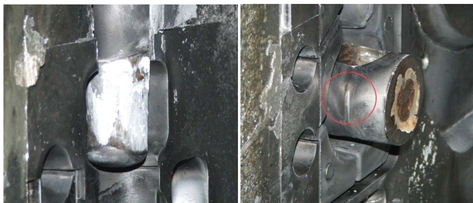
Slika 22. Reakcijsko nataljenje na jezgri alata za tlačni ljev aluminijskih radiatora s vidljivim istrošenjem površine reakcijskim nataljenjem [27]
