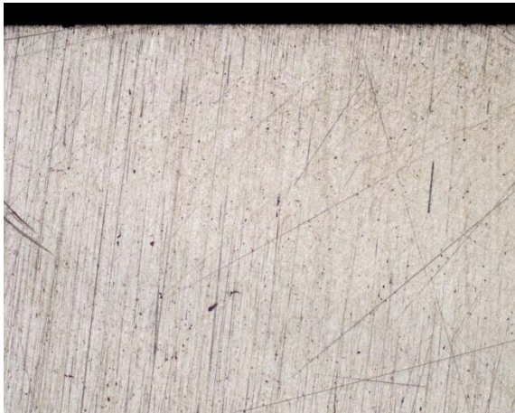
Slika 47. Mikrostruktura rubnog dijela poprečnog presjeka uzorka 2.6. (UTOP Mo1, nitriran + CO 2 oksidiran), nagriženo u NITAL-u
