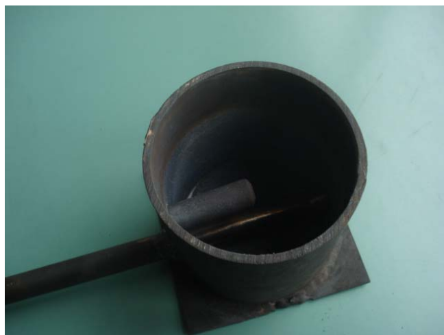
Slika 27. Retorta za provedbu postupka aluminiziranja
