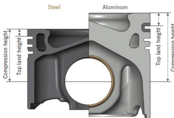
Slika 1. Konstrukcijske razlike između čeličnog i aluminijskog klipa. [8]
