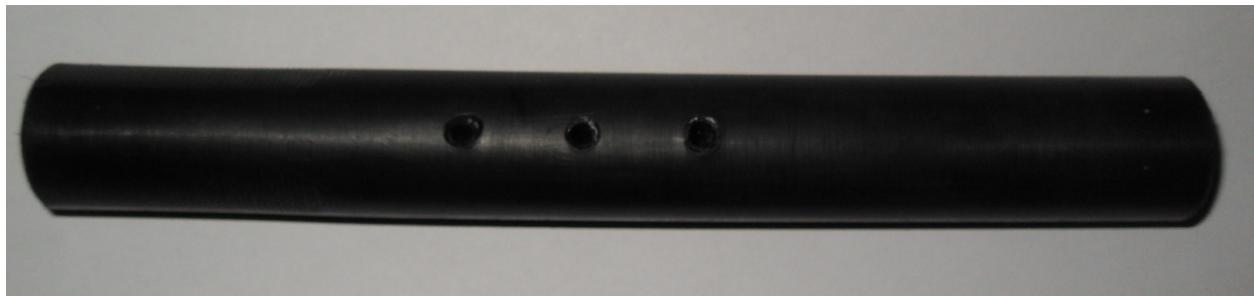
*Slika 3.9 Epruvete za provedbu eksperimenta od polietilena, PE100*
