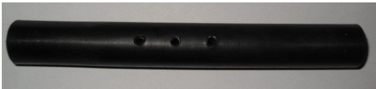
Slika 3.9 Epruvete za provedbu eksperimenta od polietilena, PE100
