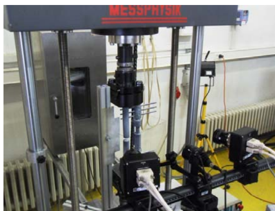
Slika 3.10 Vanjski fiksator Orthofix pripremljen za provedbu eksperimenta aksijalnog opterećenja
