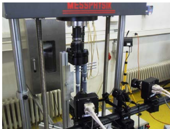
Slika 3.10 Vanjski fiksator Orthofix pripremljen za provedbu eksperimenta aksijalnog opterećenja
