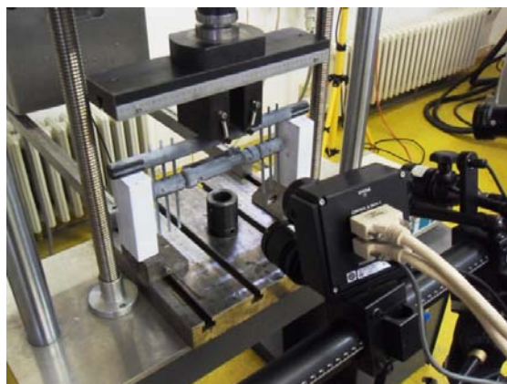
Slika 3.12 Vanjski fiksator Orthofix pripremljen za provedbu eksperimenta savijanja
