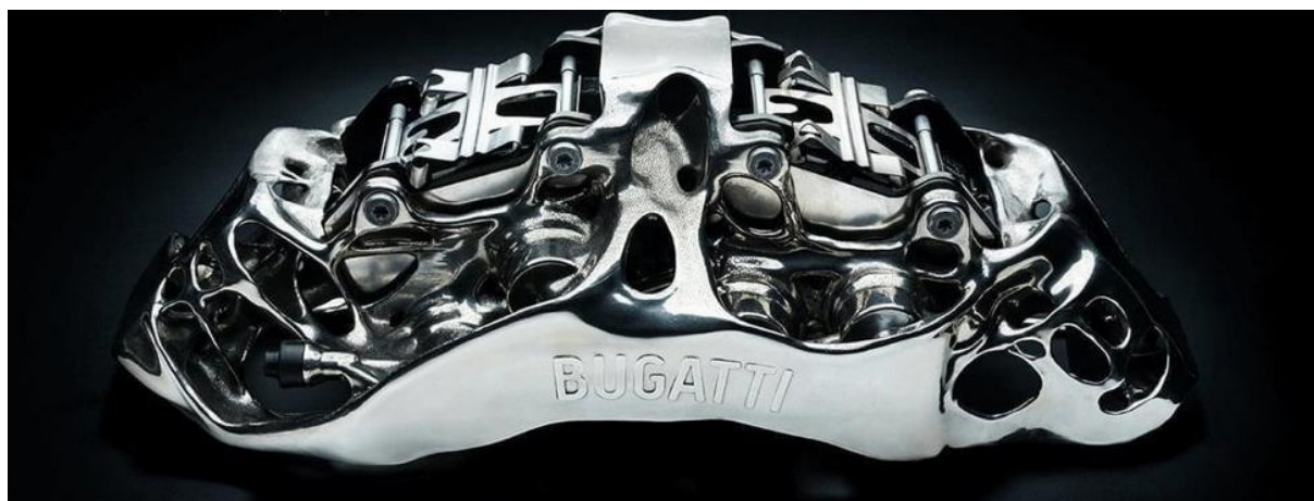
Slika 4.11. Čeljusti kočnice tvrtke Bugatti za model automobila Chiron [35]
