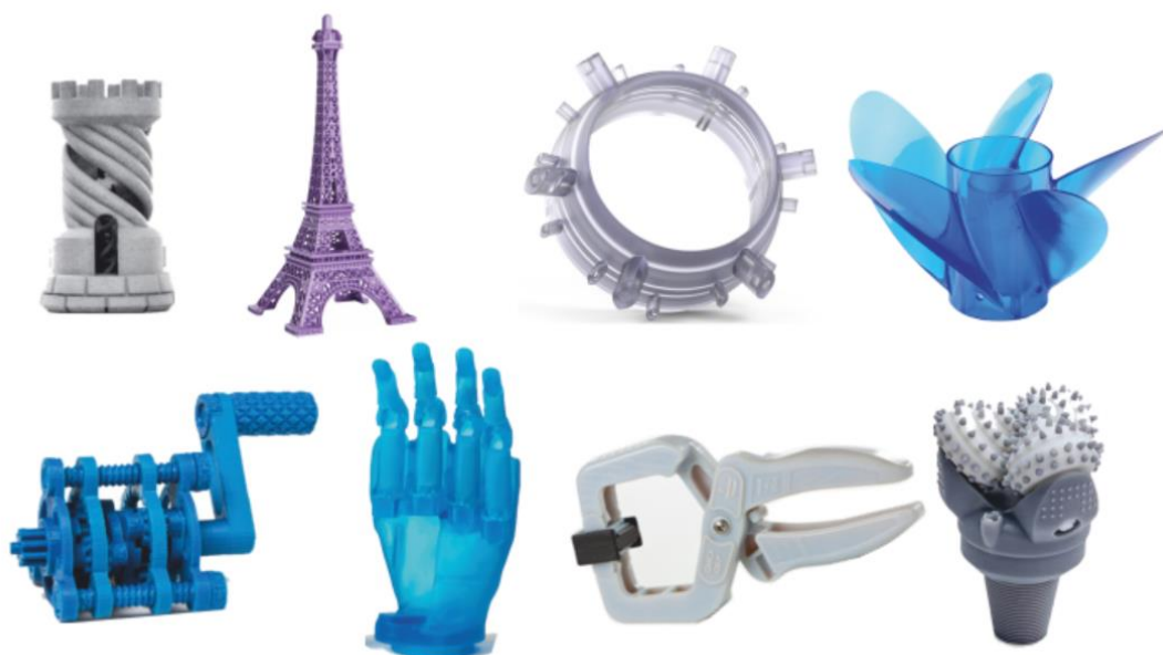
Slika 3.3. Tvorevine načinjene postupkom stereolitografije [10]
