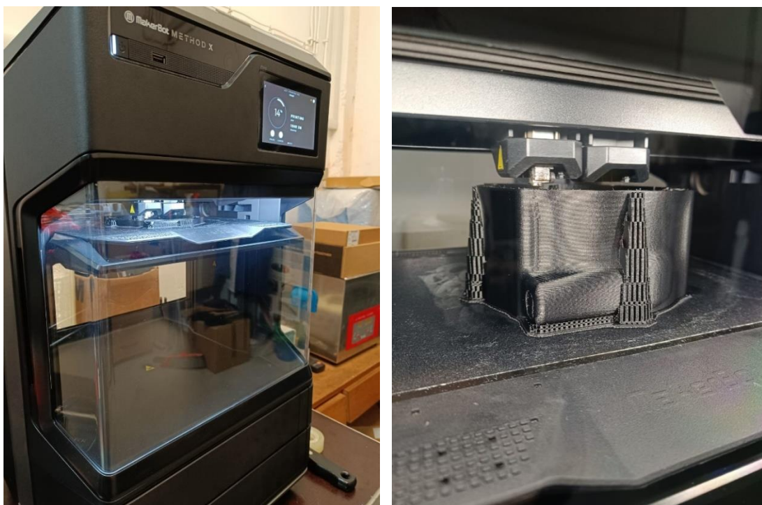
Slika 5.19. Tijek ispis kućišta cilindra od materijala PA6 ojačanog ugljičnim vlaknima
