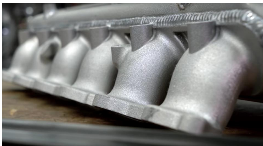
Slika 4.10. Usisni razvodnik od aluminija [34]
