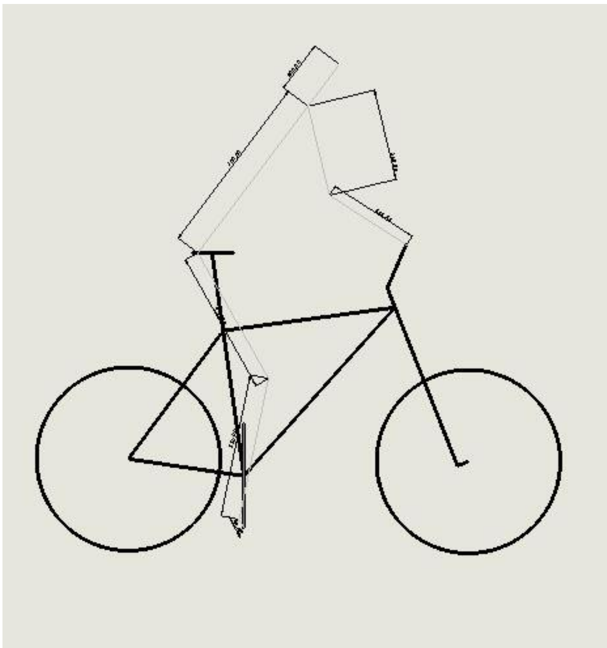
Slika 46. Žičani model vozača na referentnom štapnom modelu sklopljene bicikle
