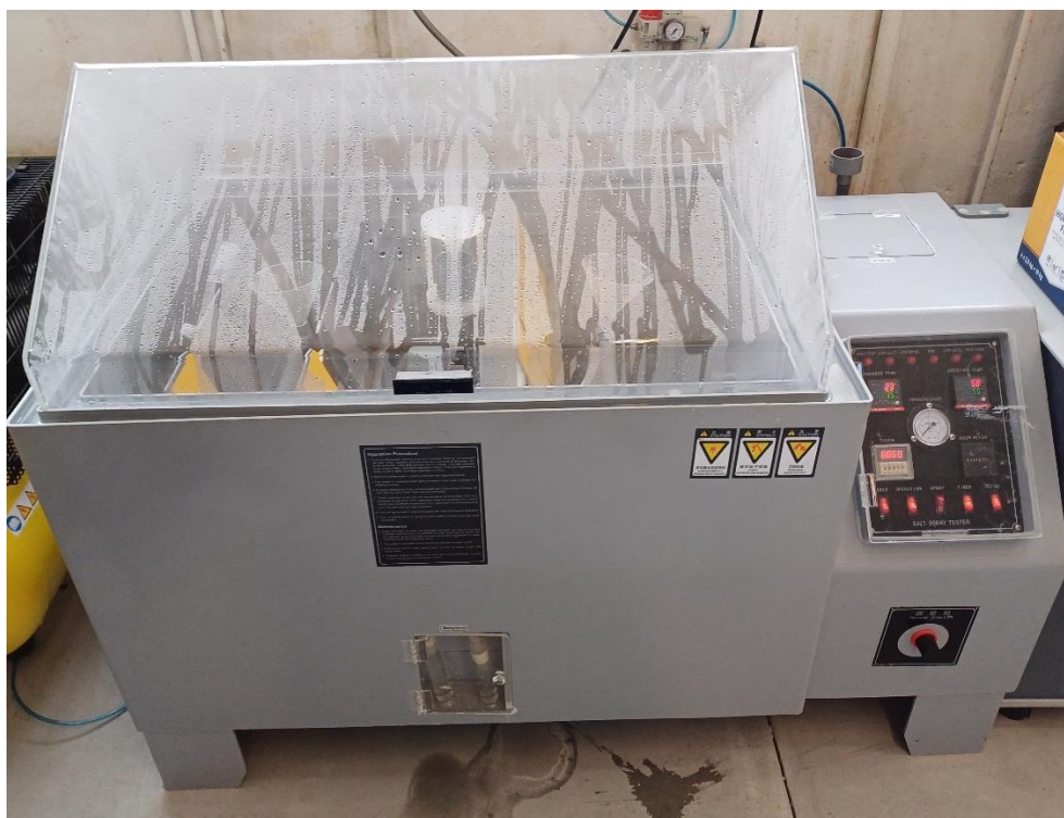
Slika 57. Slana komora „DongGuan HongTuo Instrument Co.,Ltd“ Fakultet strojarstva i brodogradnje, Laboratorij za zaštitu materijala
