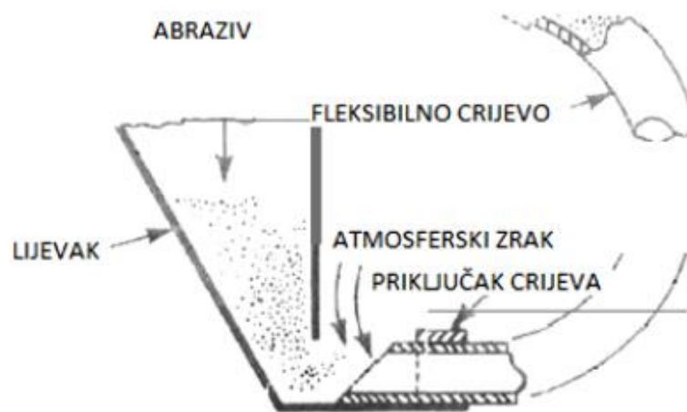
Slika 19. Metoda usisnog sifona [30]
