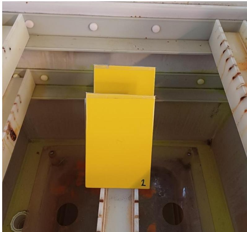
Slika 56. Uzorci postavljeni u vlažnoj komori
