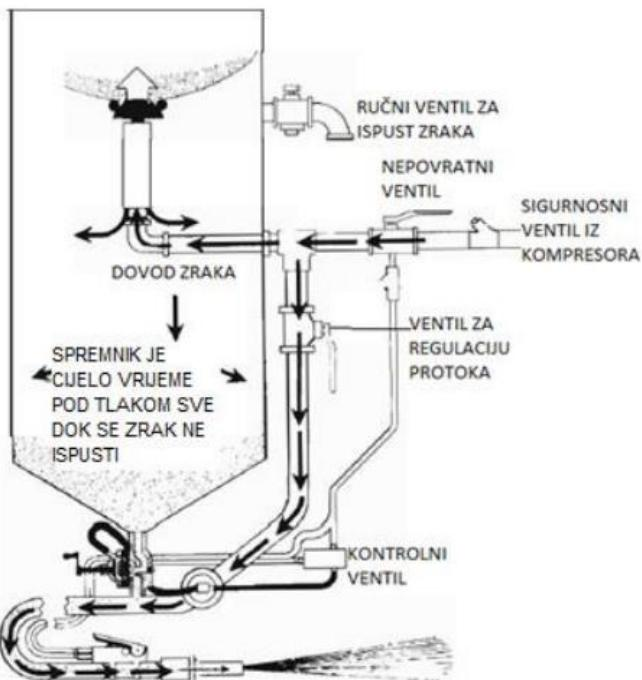
Slika 18. Oprema za pjeskarenje komprimiranim zrakom [30]
