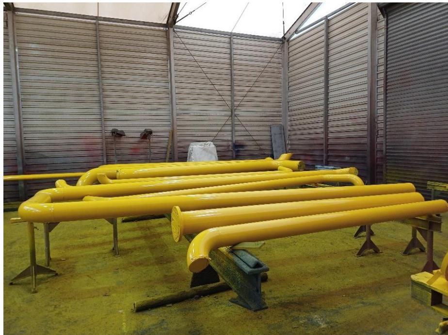
Slika 37. Cijevni elementi premazani u lakirnici
