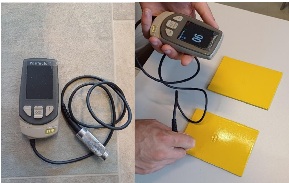
Slika 53. Mjerenje tvrdoće premaza uz pomoć uređaja „PosiTector“
