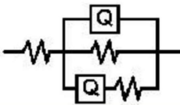
Slika 67. Ekvivalenti električni krug za ispitivane uzorke
