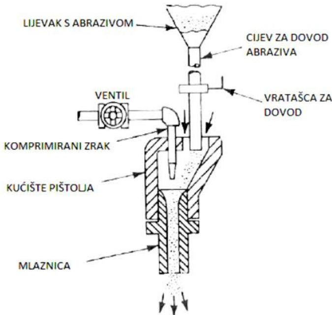
Slika 20. Gravitacijski dovod abraziva [30]
