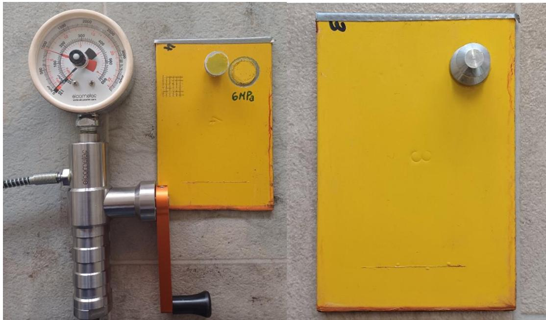
**Slika 62. Postupak ispitivanja prionjivosti vlačnom metodom**
