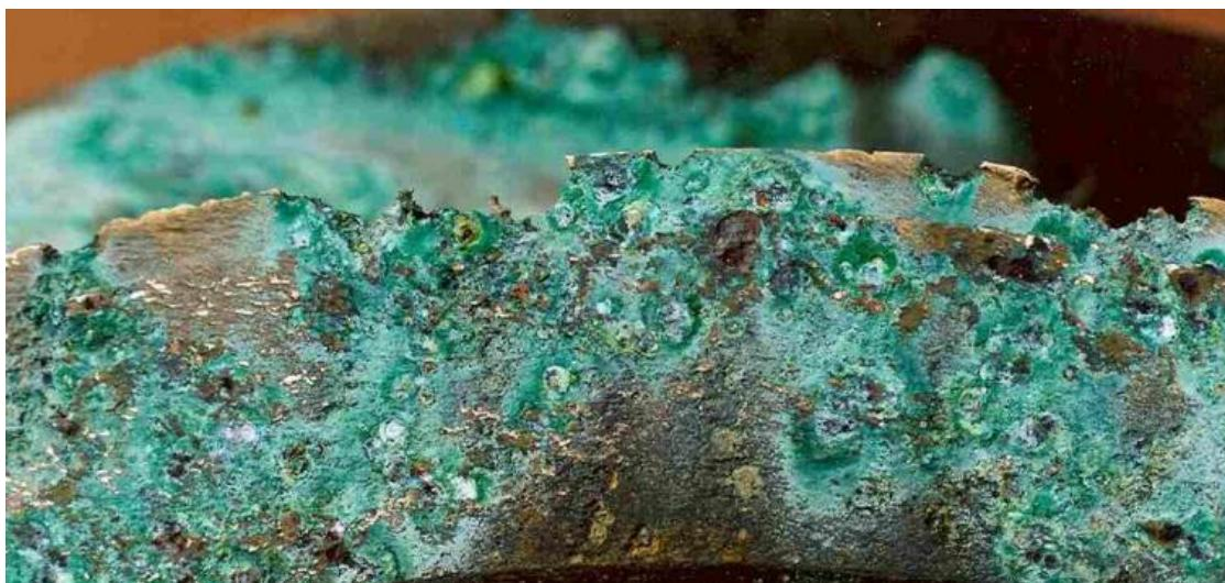
Slika 6. Erozijska korozija [17]
