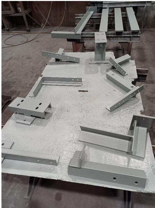
Slika 38. Oslonci premazani temeljnim slojem
