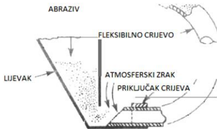
Slika 19. Metoda usisnog sifona [30]
