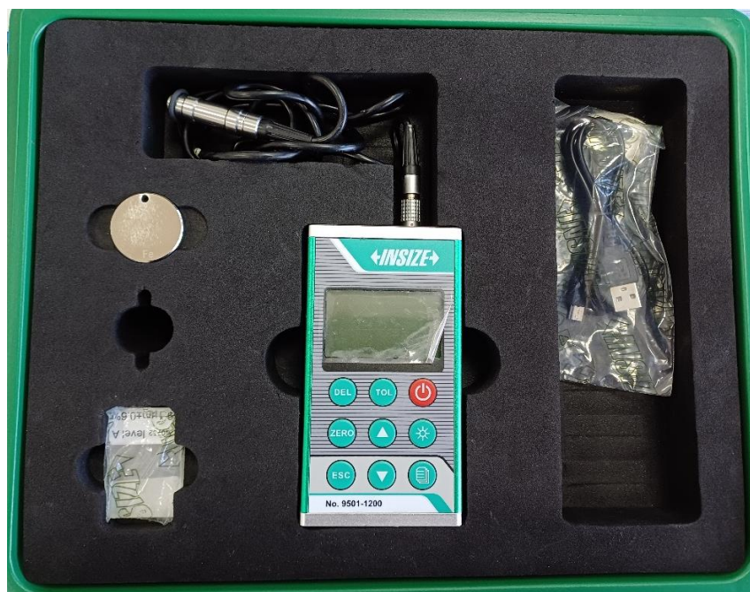
Slika 47. Uređaj za mjerenje debljine stijenke
