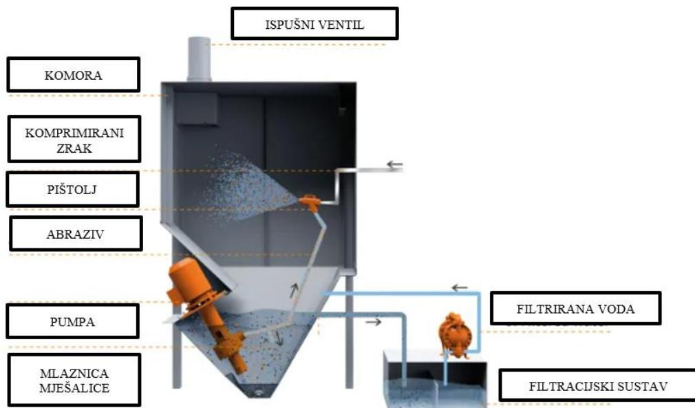
Slika 21 Oprema za mokri postupak pjeskarenja [34]
