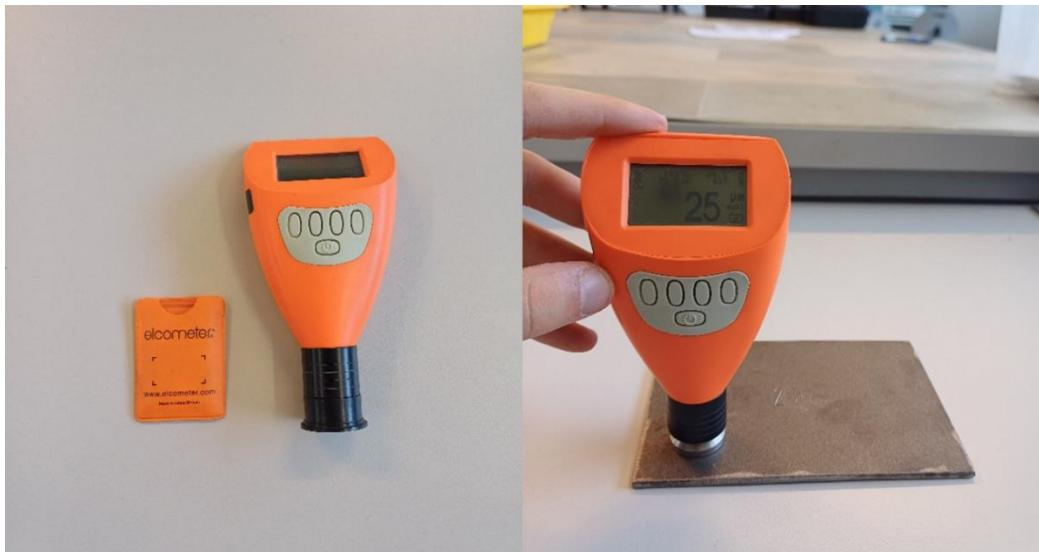
Slika 49. Mjerenje hrapavosti uređajem „Elcometer 224“
