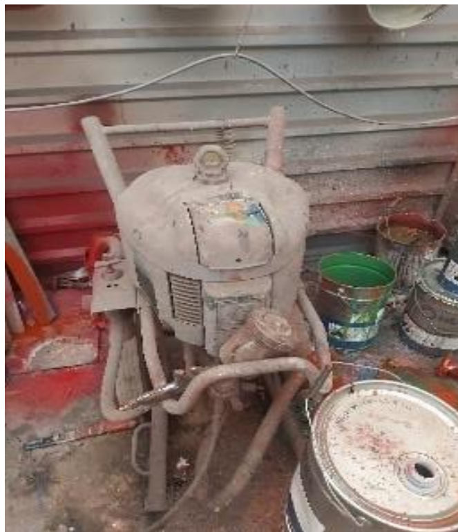
Slika 44. Uređaj za zračno prskanje
