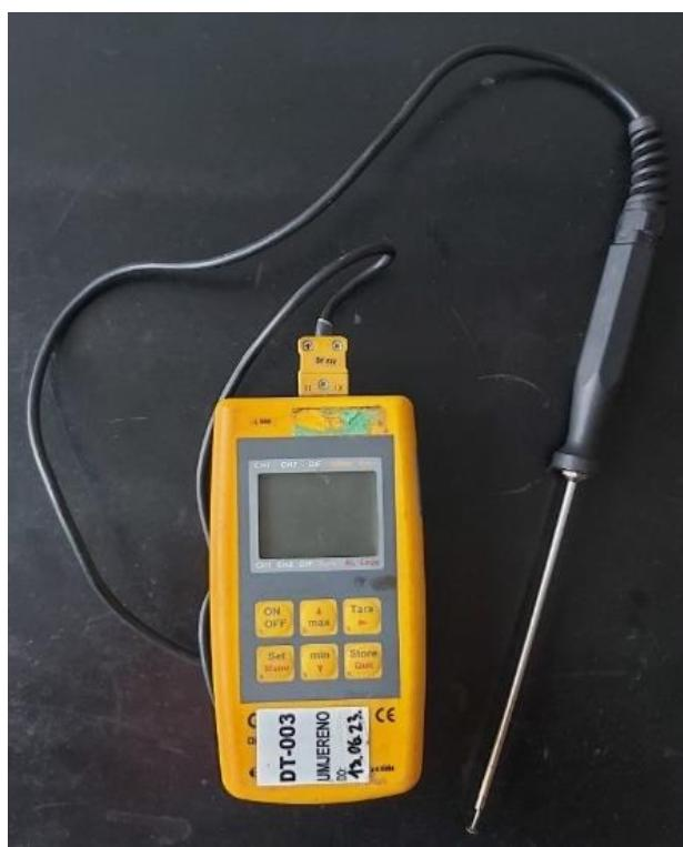
Slika 31. Kontaktni termometar
