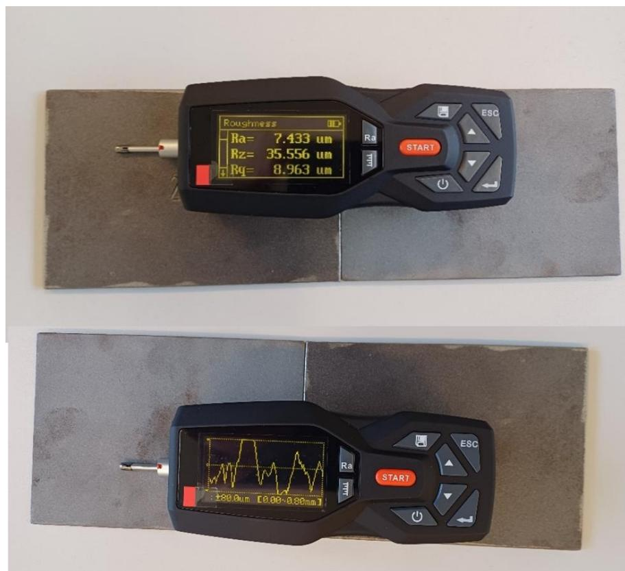
Slika 50. Mjerenje hrapavosti uređajem s pomičnim ticalom
