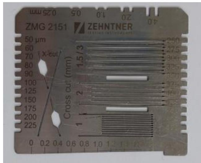
Slika 60. Etalon za urezivanje ureza
