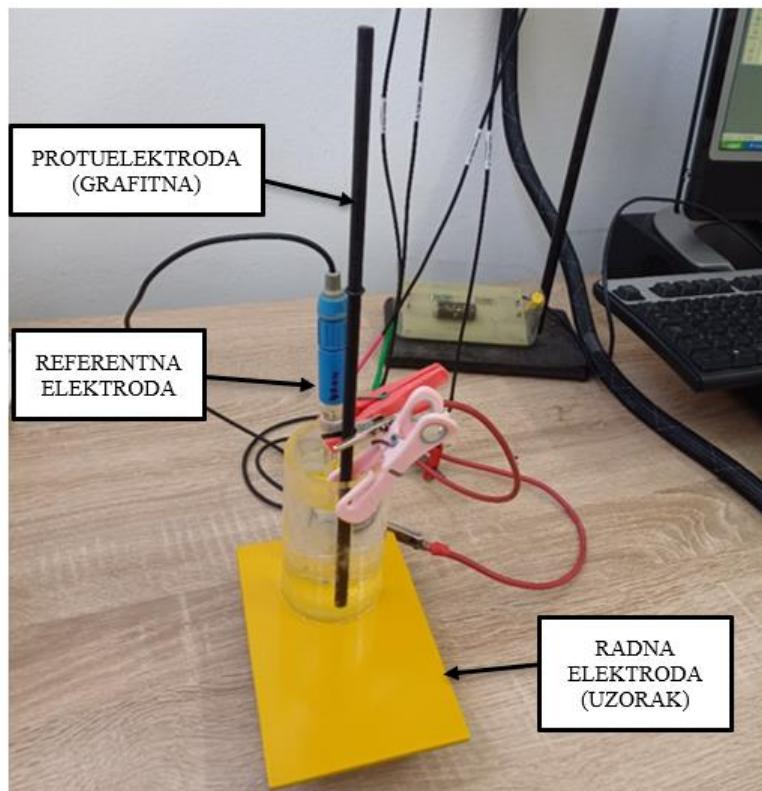
Slika 66. Aparatura za mjerjenje
