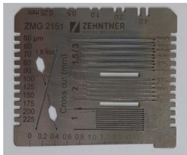
Slika 60. Etalon za urezivanje ureza
