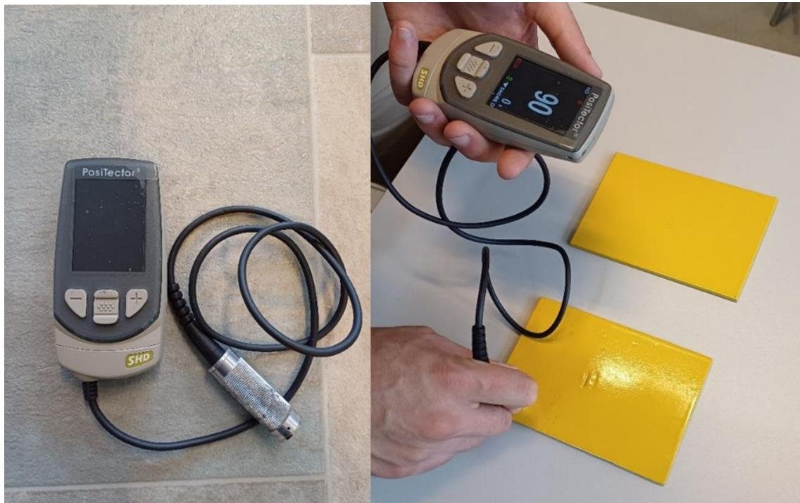
Slika 53. Mjerenje tvrdoće premaza uz pomoć uređaja „PosiTector“
