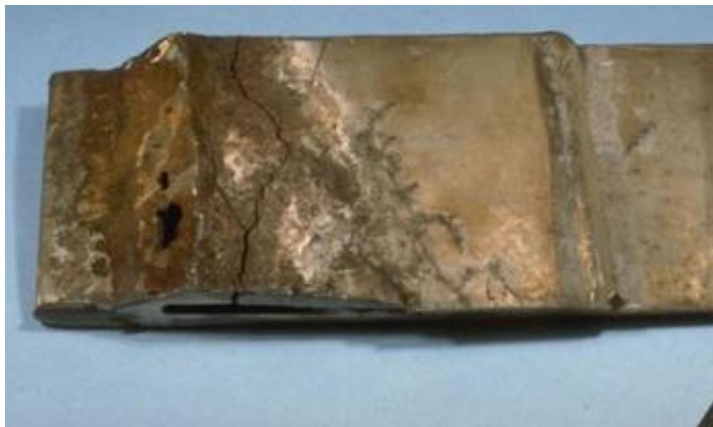
Slika 7. Napetosna korozija [9]
