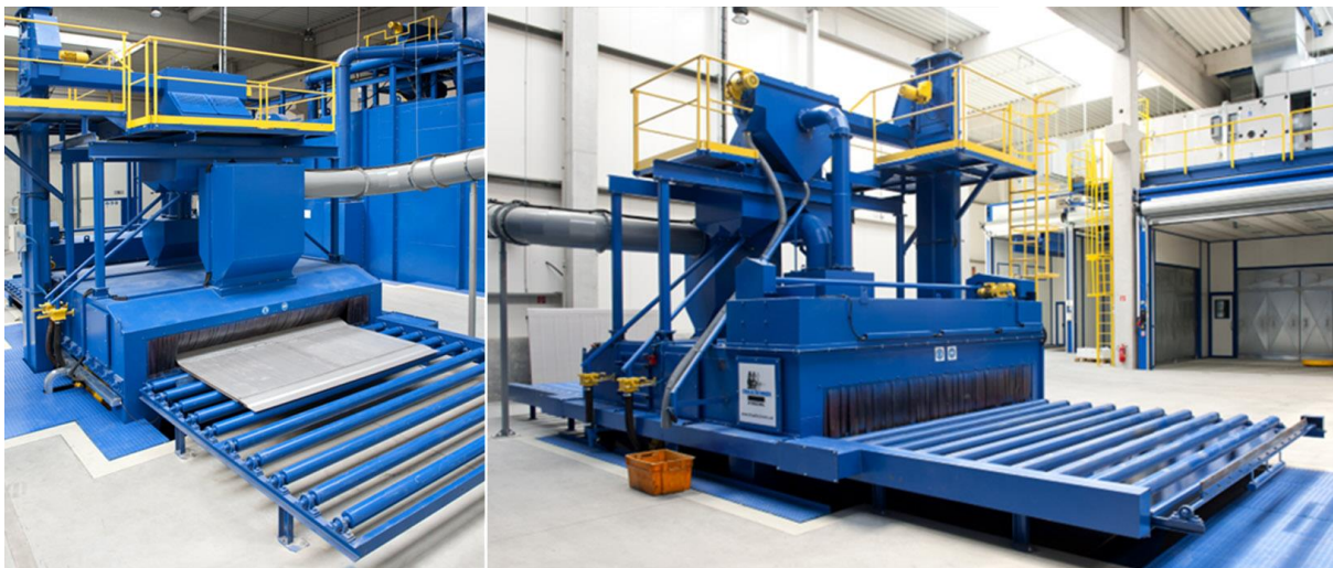
Slika 25. Postrojenje za sačmarenje [41]
