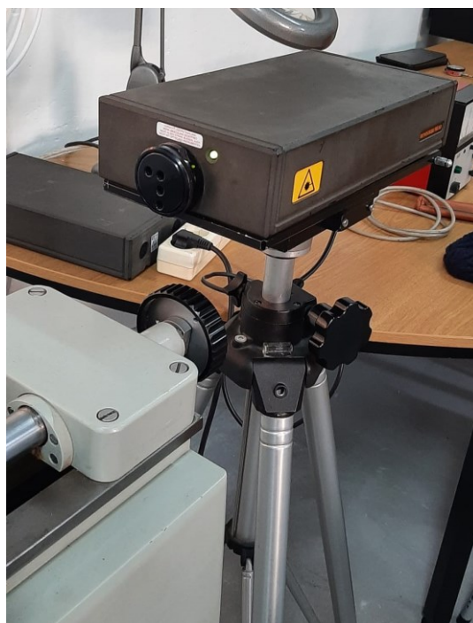
Slika 4.1 Laser Renishaw ML10
