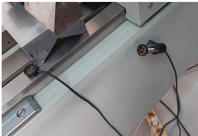
Slika 4.3 Senzori temperature zraka i materijala postavljeni na mjerni uređaj
