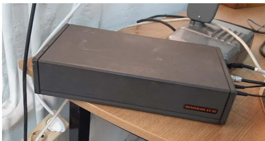
Slika 4.2 Jedinica za kompenzaciju okoline EC10
