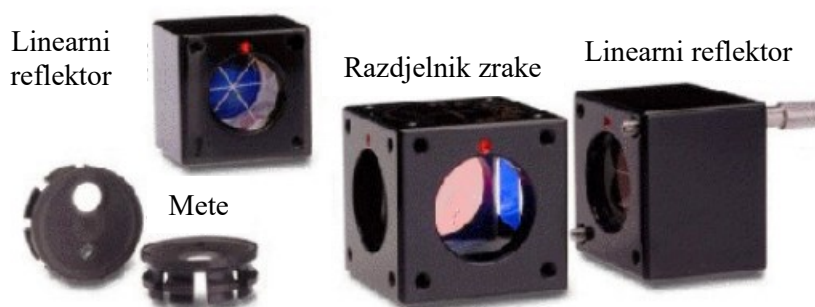
Slika 4.5 Linearna mjerna optika [2]
