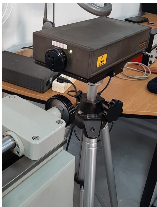
Slika 4.1 Laser Renishaw ML10
