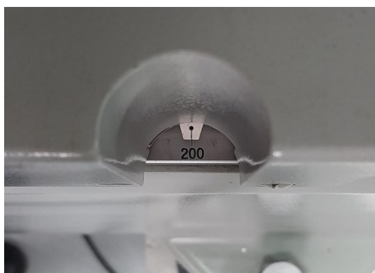
Slika 4.7 Kolica grubo pozicionirana na vrijednost od 200 mm
