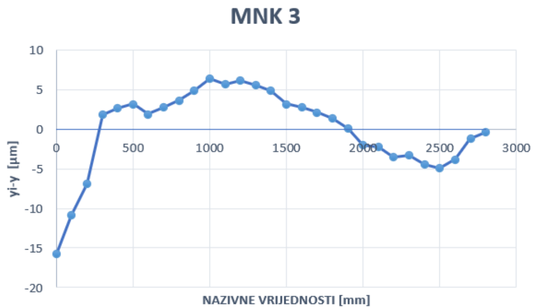
Slika 61. Odstupanje trećeg mjerenja od horizontalne pravocrtnosti
