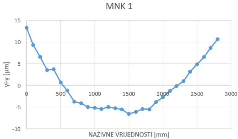
Slika 72. Odstupanje prvog mjerenja od vertikalne pravocrtnosti
