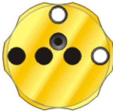
Slika 4. Položaj zatvarača ML10 - nema izlaza snopa
