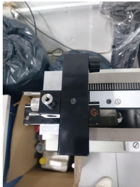
Slika 48. Reflektor pravocrtnosti - odozgor
