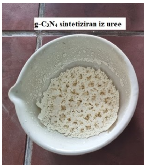
Slika 16. Uzorak g\text{-C}_3\text{N}_4 sintetiziran iz uree
