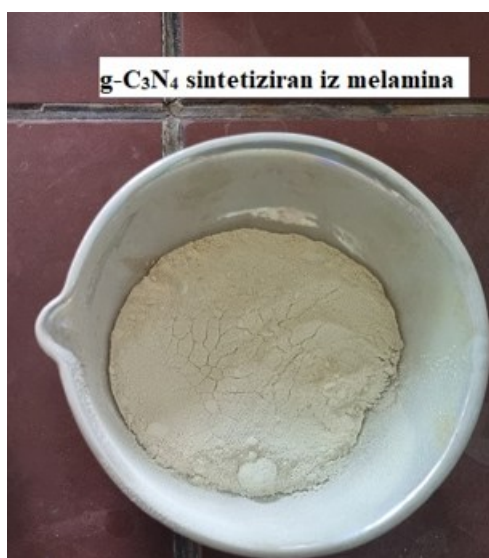
Slika 17. Uzorak g\text{-C}_3\text{N}_4 sintetiziran iz melamina
