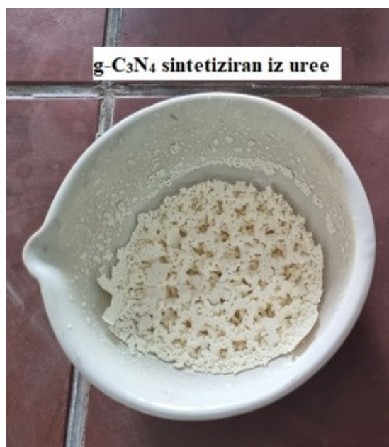
Slika 16. Uzorak g\text{-C}_3\text{N}_4 sintetiziran iz uree
