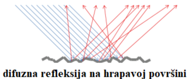
Slika 23. Shematski prikaz difuzne refleksije [45]
