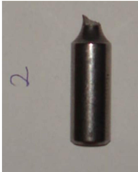
Slika 4.6 Epruveta nakon loma
