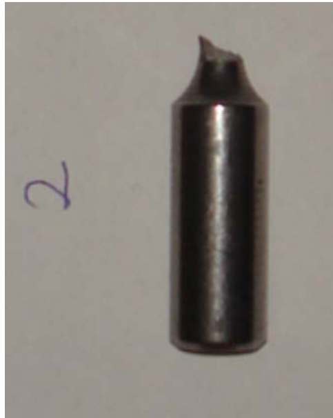
Slika 4.6 Epruveta nakon loma
