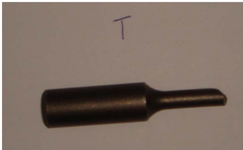
Slika 4.10 Epruveta iz četvrte grupe nakon loma
