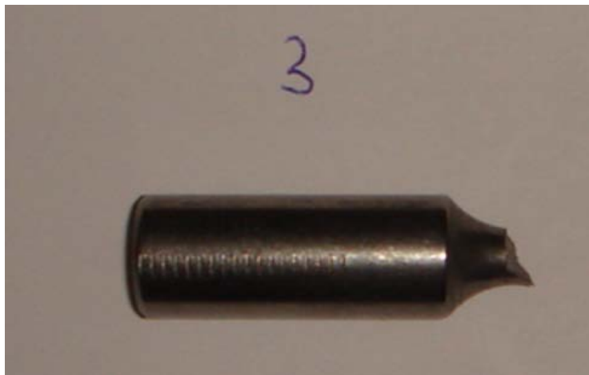
Slika 4.8 Epruveta iz treće grupe nakon loma
