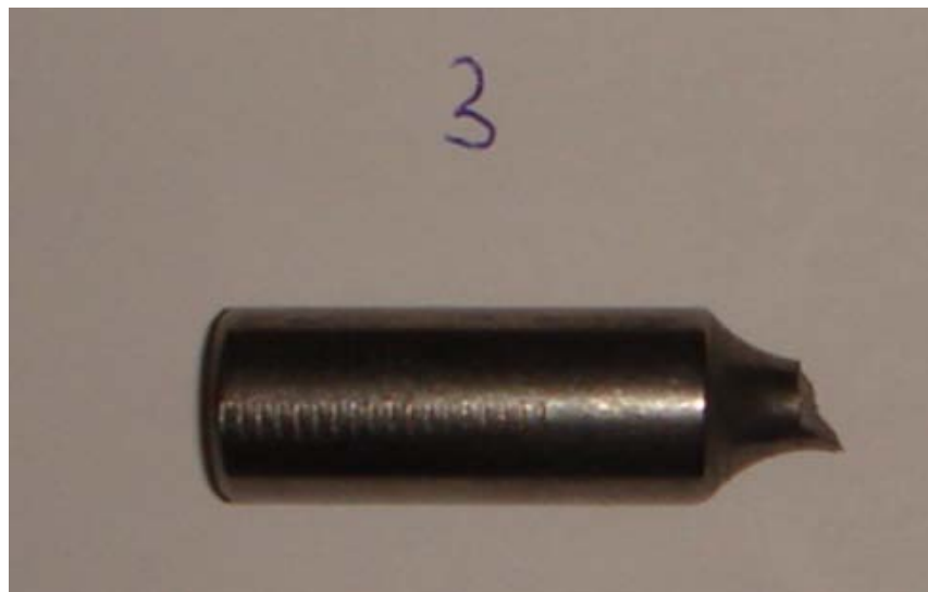
Slika 4.8 Epruveta iz treće grupe nakon loma
