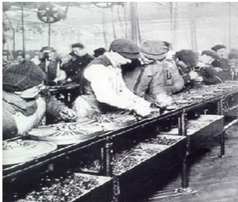
Slika 1.2.2. Pokretna montažna traka, [1]
