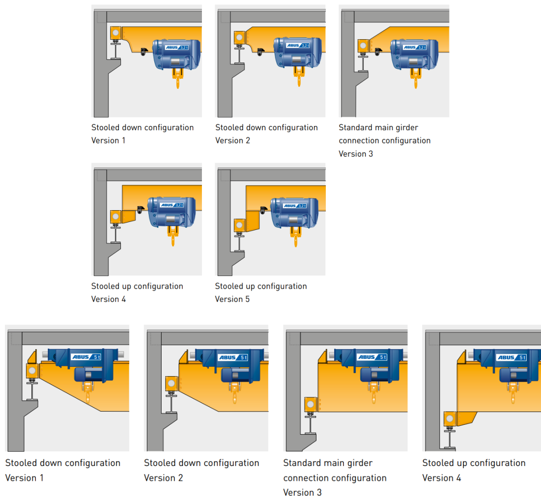
Slika 3. Abus crane systems – Singel girder overhead travelling crane opcije voznih staza i vitla
