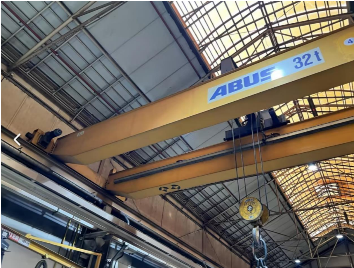
Slika 13. Mosni granik s dva glavna nosača kutijastog profila
