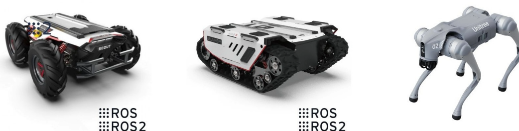
Slika 2.1: Kretanje po tlu; kotači: Scout 2.0 (Agilex), gusjenica: Bunker (Agilex), noge: Go 2 Air (Unitree Robotics) 1
