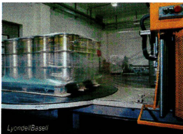
Slika 3.3. Novi metalocenski PE-LLD za rastezljive filmove 15
