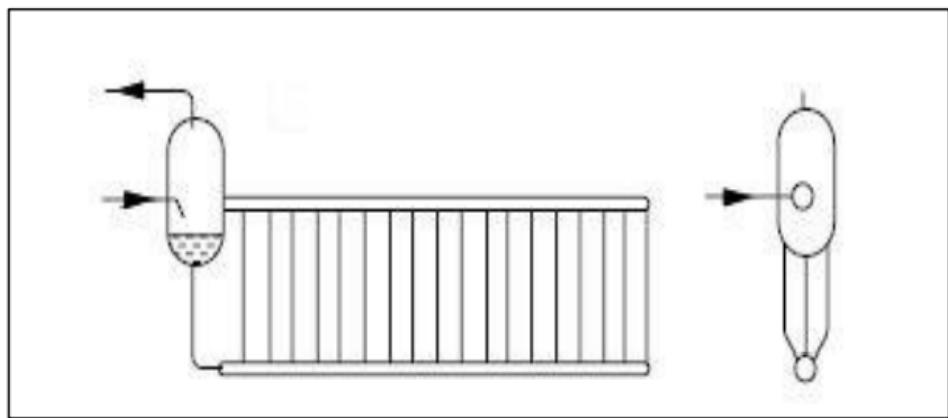
Slika 14. Shematski prikaz isparivača s uspravnim cijevima
