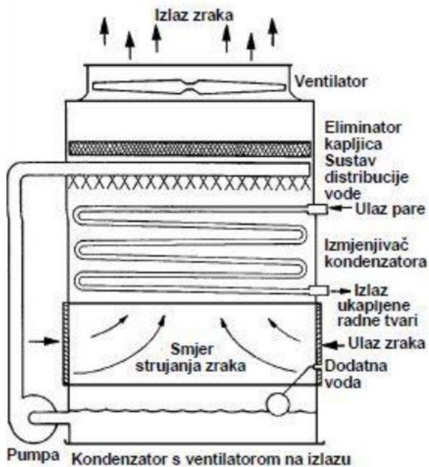
Slika 15. Evaporativni kondenzator s aksijalnim ventilatorom na izlazu [7]
