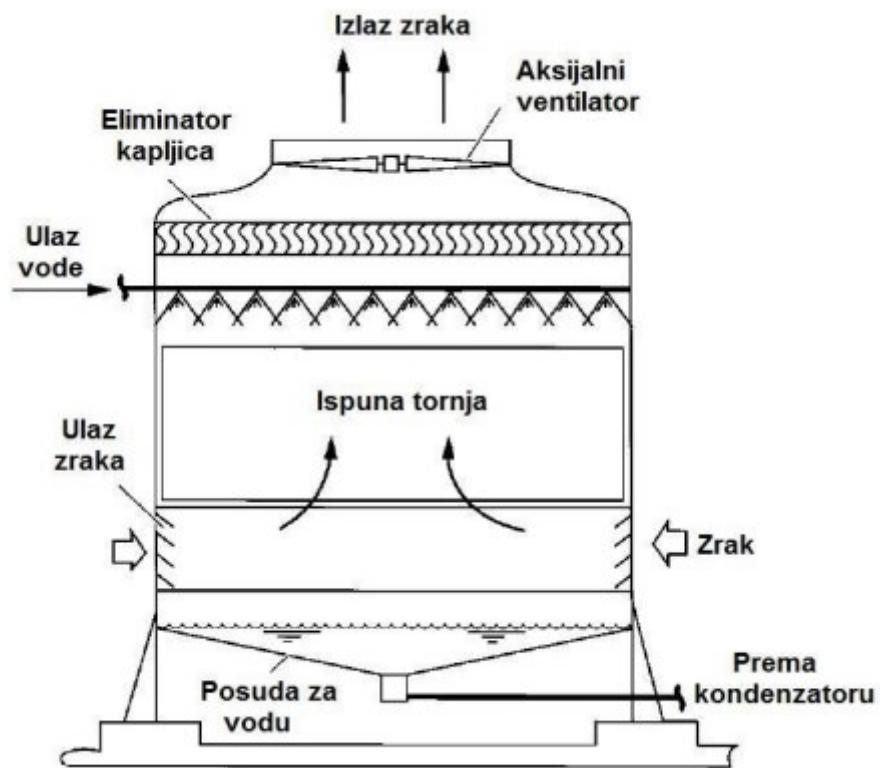
Slika 10. Protusmjerni rashladni toranj s induciranim strujanjem
