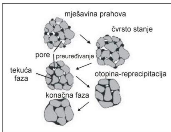
Slika 6. Faze zgušnjavanja kod sinteriranja u prisutnosti tekuće faze [1]
