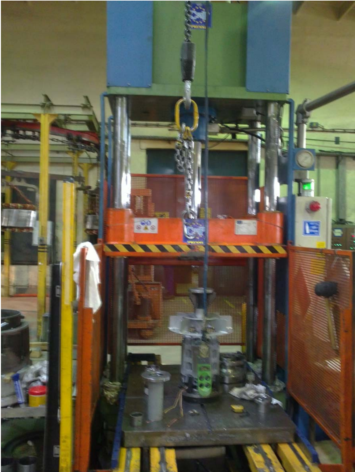
Slika 13. 100 t preša koja služi za uprešavanje vratila u rotore generatora
