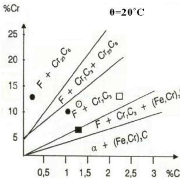
Slika 6. Izotermički presjek stava Fe-Cr-C pri 20°C
