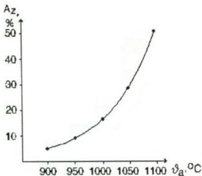
Slika 9. Udjeli zaostalog austenita (Az) u čeliku X155 CrVMo 12 1 kaljenom s različitim temperaturama [1]
