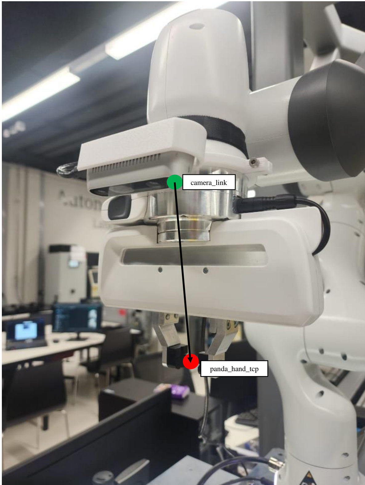
Slika 16. Položaj kamere u odnosu na robota („ eye-in-hand “)
