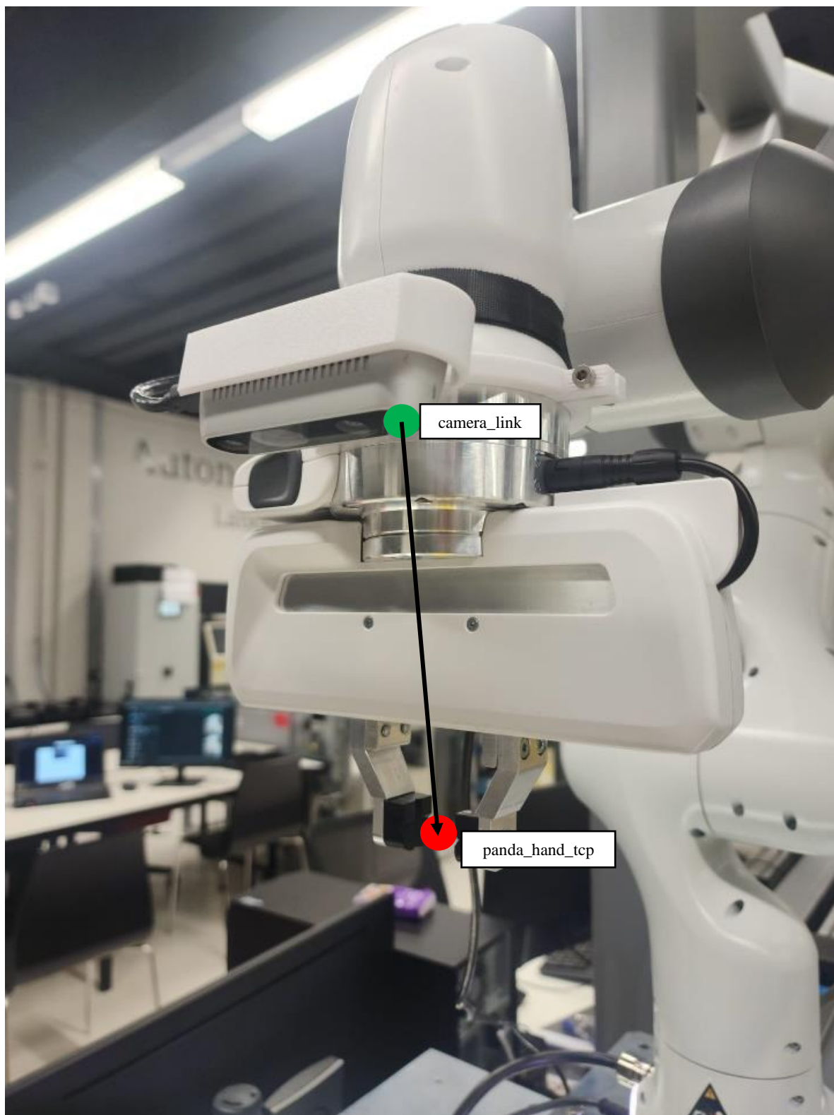
Slika 16. Položaj kamere u odnosu na robota („ eye-in-hand “)
