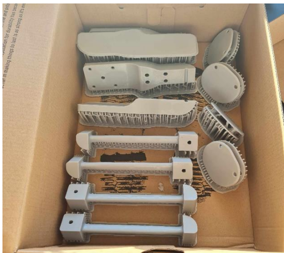
Slika 3.14 Komponente printane Elegoo Saturn 8K printerom
