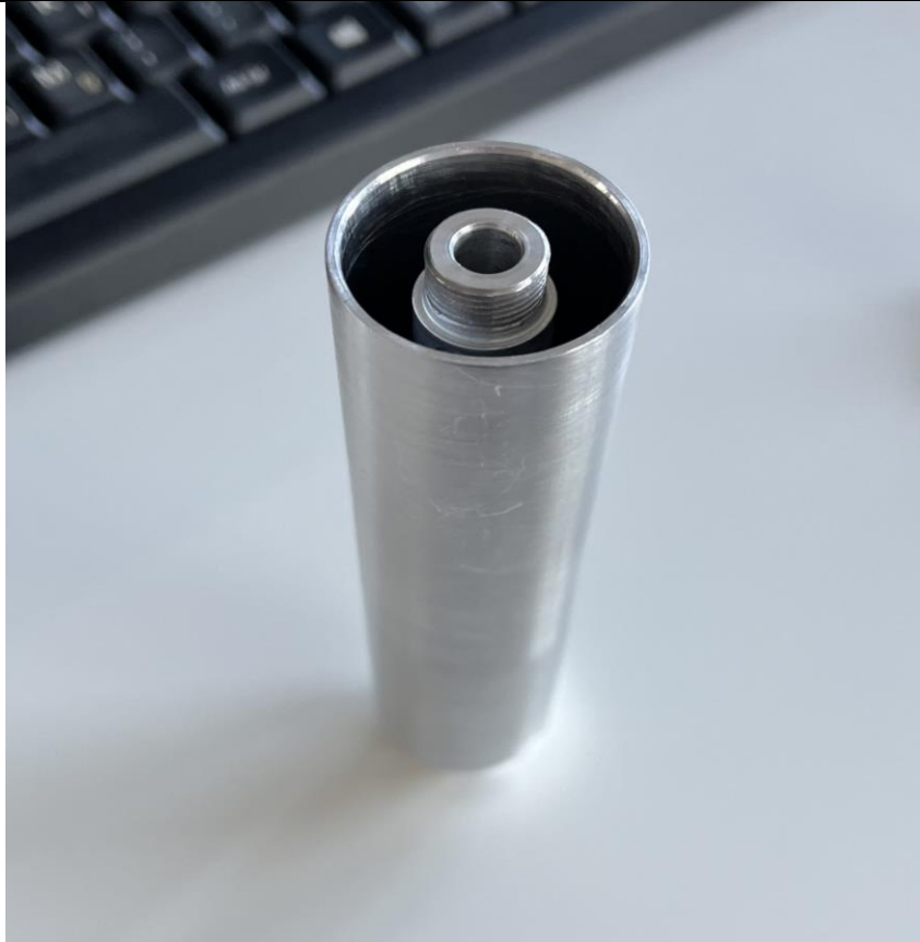
Slika 19. Moderator zvuka od aluminija bez ispune
