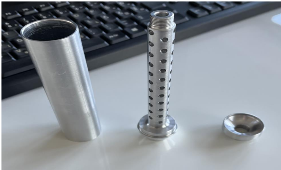
Slika 18. Prikaz dijelova moderatora zvuka od aluminija
