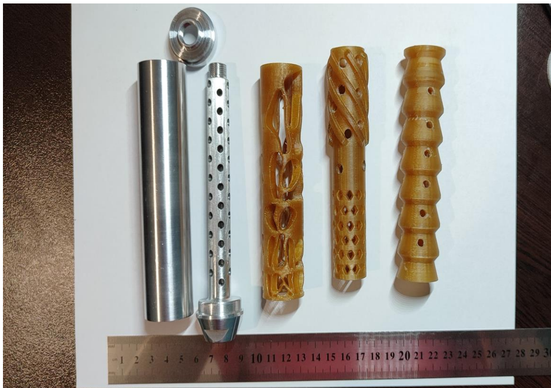
Slika 35. Prikaz svih modela izradenih FDM postupkom
