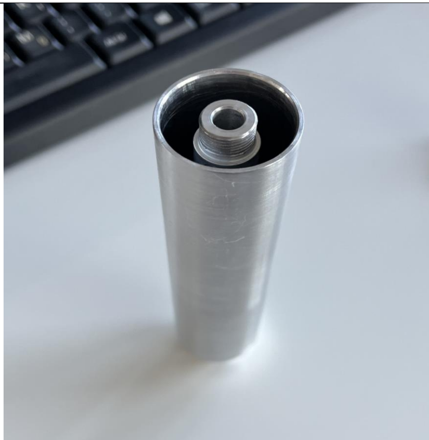
Slika 19. Moderator zvuka od aluminija bez ispune
