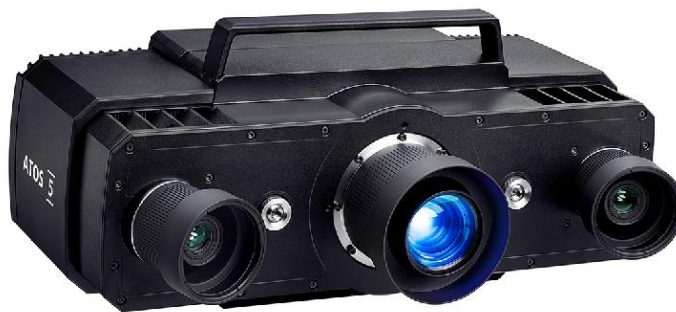
Slika 8. Izgled laserskog digitalizatora Atos 5X [15]
