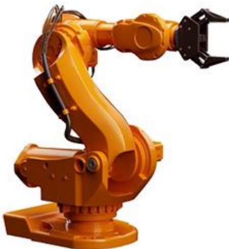
Slika 1. Serijska kinematska struktura na primjeru artikuliranog robota [4]
