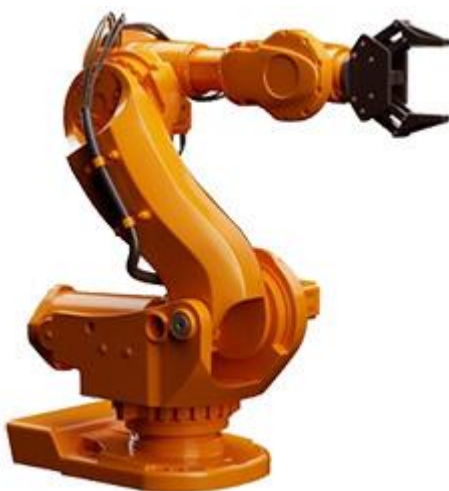
Slika 1. Serijska kinematska struktura na primjeru artikuliranog robota [4]
