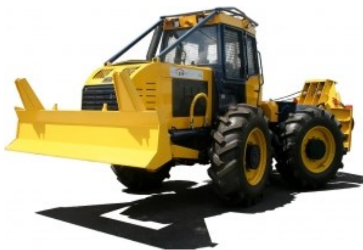
Slika 1. Šumski zglobni traktor EcoTrac 140V [2]
