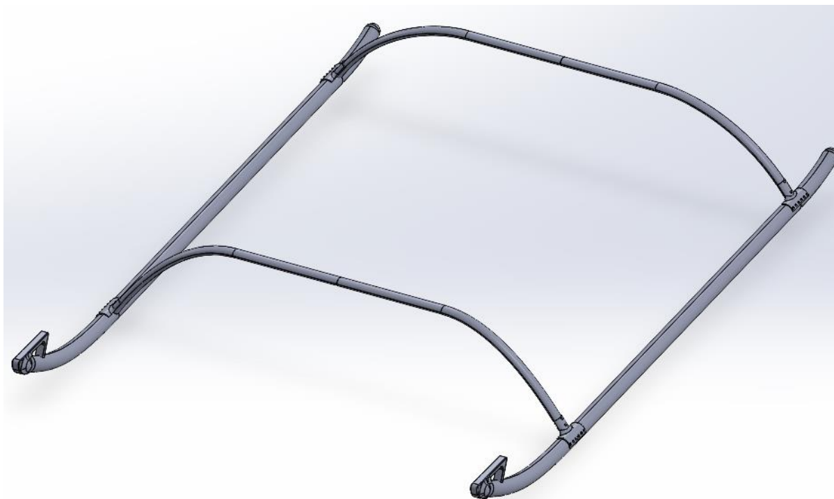
Slika 31. CAD model podvozja helikoptera
