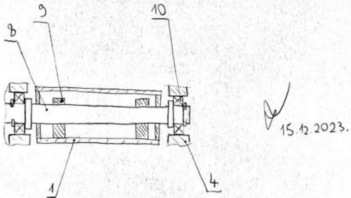
**Slika 16 Presjek vibrаторa koncepta 1**
