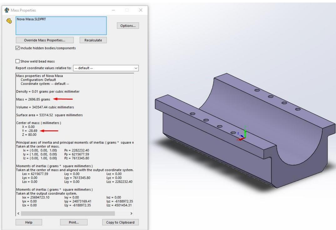
**Slika 45 Novi volumen vibracijske mase i njezine karakteristike**
