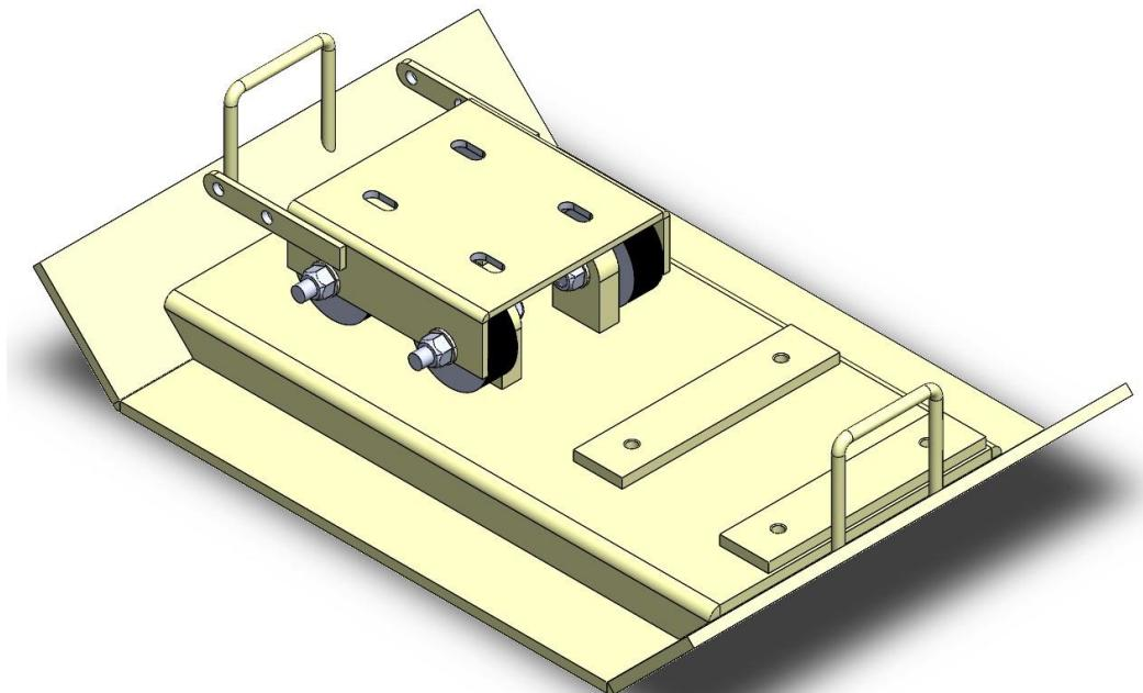
**Slika 57 Radna ploča i temeljna ploča pogonskog motora**
