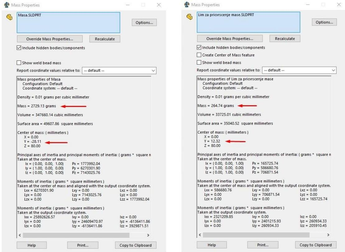
Slika 38 Mass Properties, vibracijska masa (lijevo), lim (desno)
