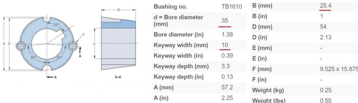
Slika 30 SKF stezna čahura PHF TB1610x35 [16]
