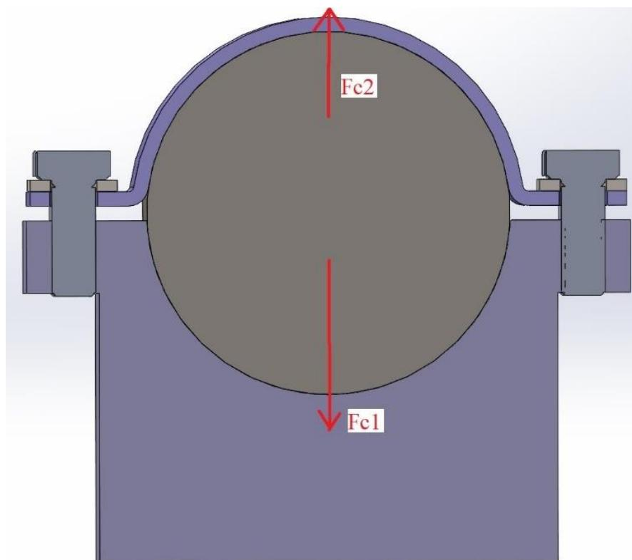
Slika 37 Centrifugalne sile koje opterećuju vijčani spoj
