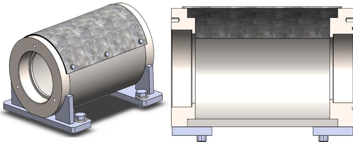
**Slika 50 Kućište vibratora (lijevo), presjek kućišta (desno)**
