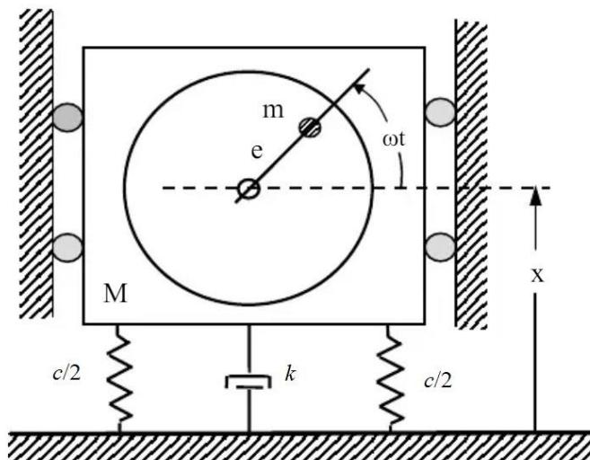
Slika 49 Model sustava s jednim stupnjem slobode gibanja
