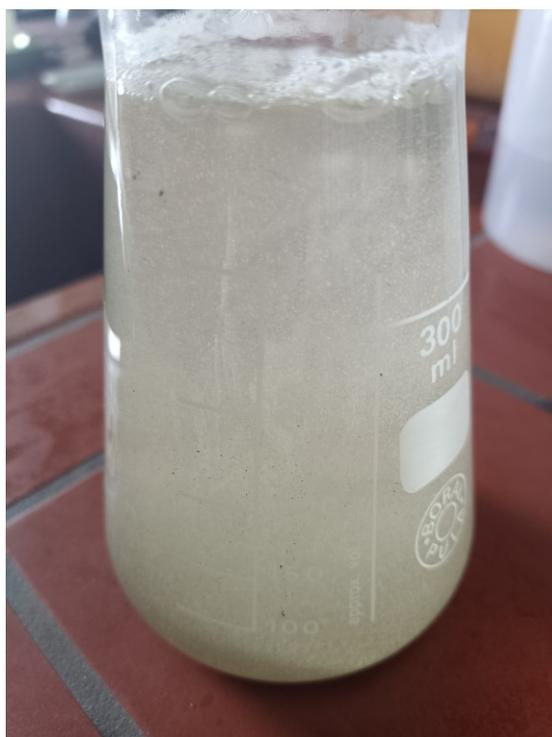
**Slika 20. Uzorak TiO<sub>2</sub> nakon mikrovalno potpomognute sinteze**
