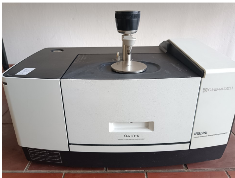
Slika 37. Spektrometar (IRSpirit, Shimadzu, Tokyo, Japan)
