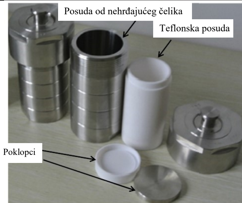
Slika 10. Komercijalno dostupna posuda od nehrđajućeg čelika obložena teflonom [19]
