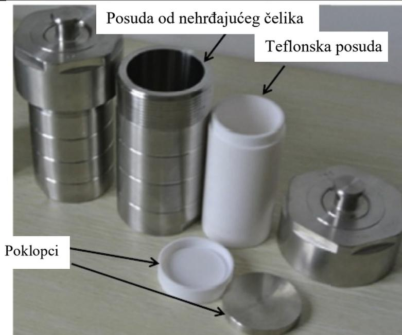
Slika 10. Komercijalno dostupna posuda od nehrđajućeg čelika obložena teflonom [19]
