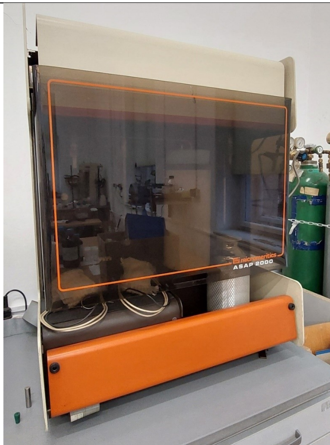
Slika 39. Uređaj za određivanje veličina pora (ASAP-2000, Micromeritics, SAD)
