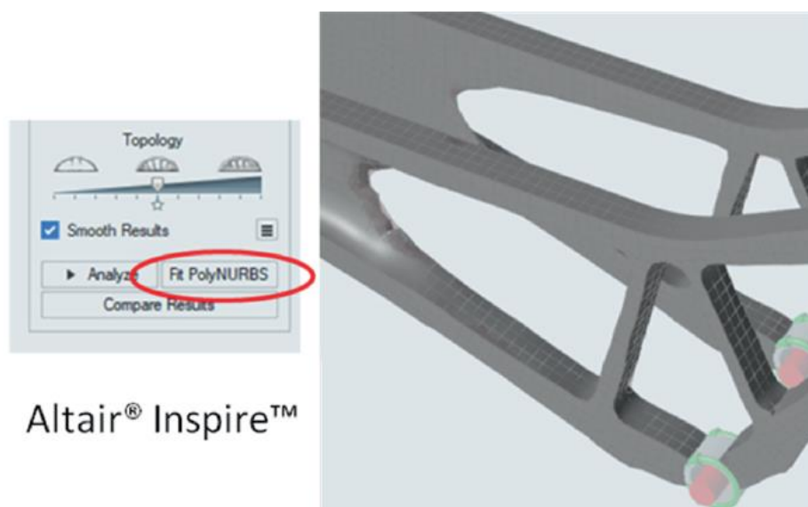
Slika 14. Korištenje NURBS interpretacije modela u programskom paketu Altair Inspire [1, 10]
