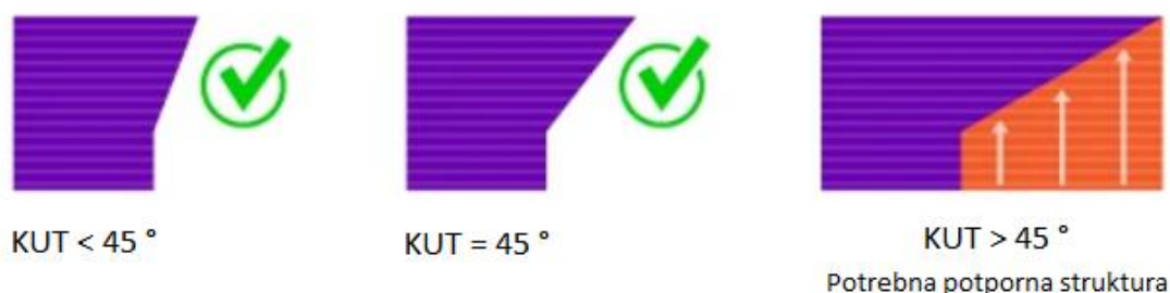
Slika 31. Primjer implementacije samonosivog kuta mjenog u odnosu na smjer izgradnje proizvoda [16]
