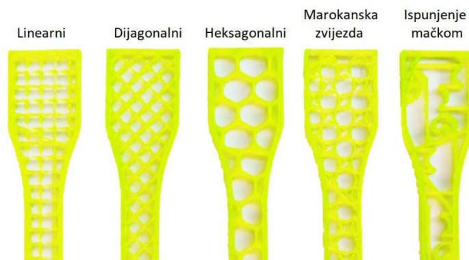
Slika 29. Prikaz različitih oblika ispune poprečnog presjeka [13]
