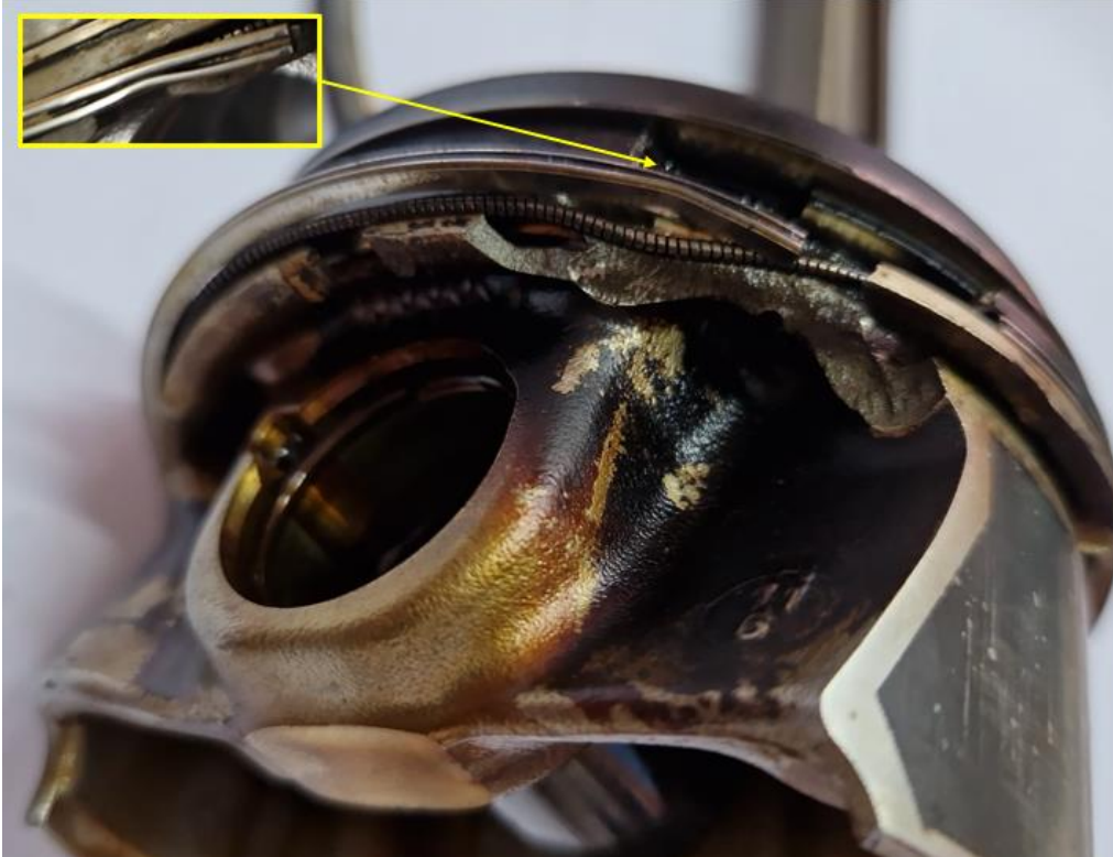
Slika 18. Neodmašćeni oštećeni klip, donja perspektiva
