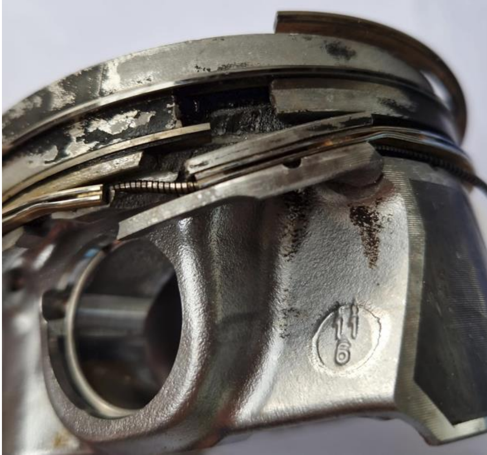
Slika 21. Prikaz loma na odmašćenom klipu s odlomljenim dijelovima klipa
