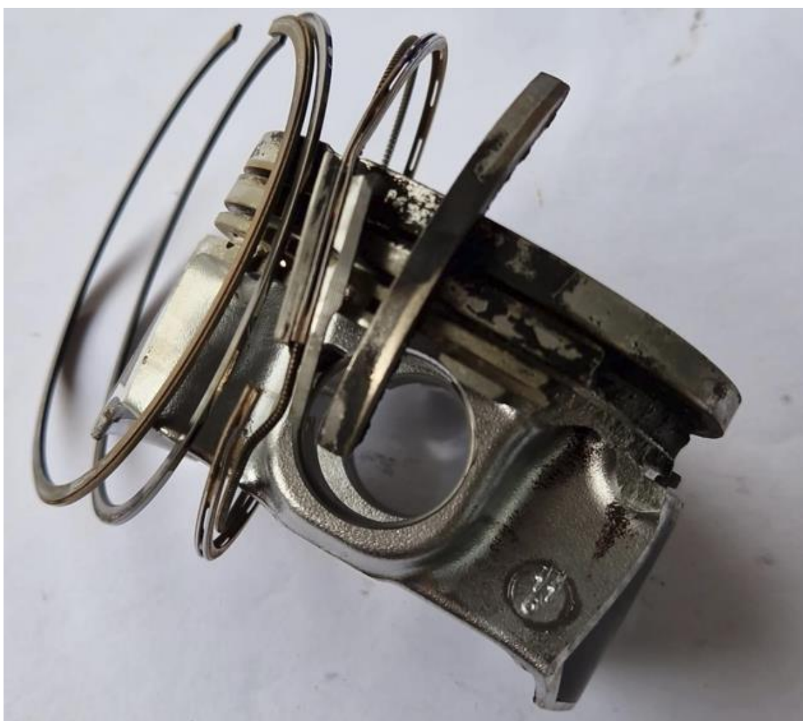
Slika 20. Odmašćeni oštećeni klip s kompresijskim i uljnim prstenovima i odlomljenim dijelovima klipa
