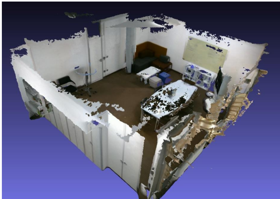
Slika 2.15 3D rekonstrukcija unutrašnjosti sobe
