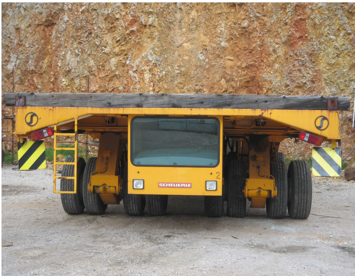
Slika 11 Transporter za prijevoz sekcija trupa i blokova spremnika
