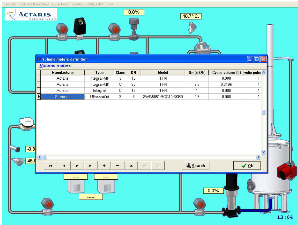
Slika 8.4 Unos vrste protokomjera i njegovih karakteristika u program
