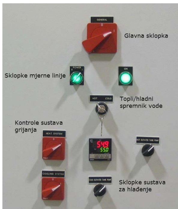
Slika 8.1 Ormarić sa prekidačima za pokretanje mjerne linije
