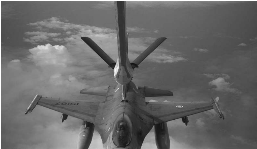
Slika 5.13 Flying boom metoda punjenja goriva u zraku na zrakoplovu F-16
