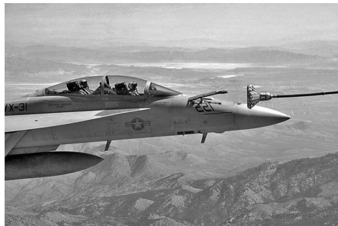
Slika 5.12 Primjer „mekanog“ punjenja goriva u letu na zrakoplovu F-18
