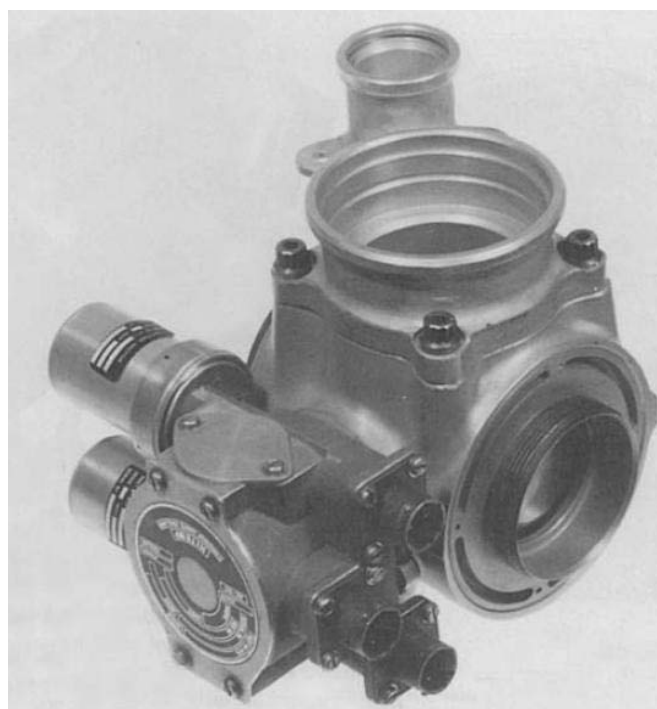
Slika 3.4 Ventil za transport goriva pogonjen rotacijskim aktuatorom [15]
