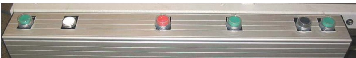
Slika 8.3 Tipke za otvaranje i zatvaranje mjerne linije
